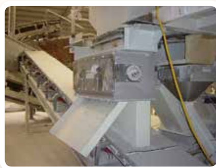
Separator bębnowy z osiowym polem magnetycznym o wartości 3000 Gauss odpowiedni do zastosowań np. w przemyśle ceramicznym.
