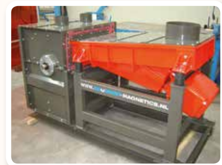
Separator bębnowy w całkowicie pyłoszczelnej obudowie odpowiedni dla przemysłu ceramicznego, osiąga wartości pola magnetycznego 6000 Gauss.
