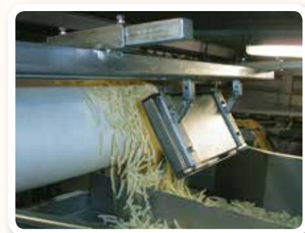
Płyta magnetyczna do usuwania cząsteczek ferromagnetycznych z frytek.
