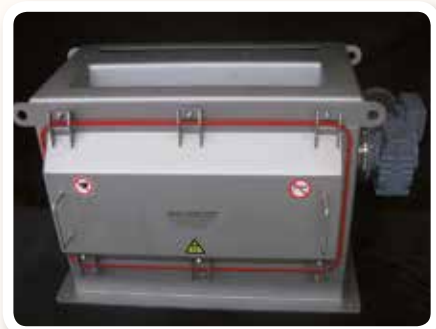
Separator bębnowy Neoflux® (Nd-Fe-B) z radialnym polem magnetycznym o wartości 6000 Gauss. Całość wykonania w stali nierdzewnej.
