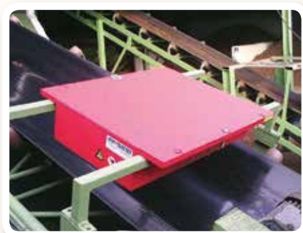
Nadaśmowa ferrytowa płyta magnetyczna do usuwania cząsteczek magnetycznych z ziemi ogrodowej.
