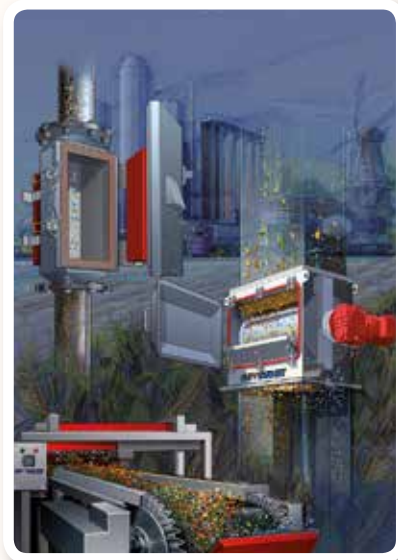
Płyty magnetyczne do usuwania zanieczyszczeń gruboziarnistych.
