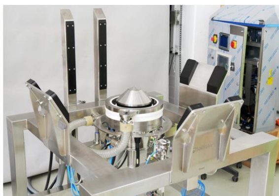
Stacja opróżniania zbiorników z systemem samocentrującym
