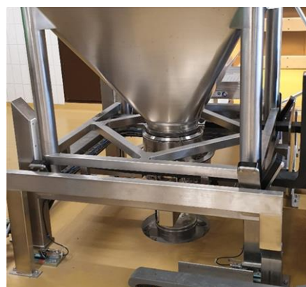
Stacja opróżniania zbiorników z czujnikami wagowymi
